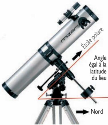
▲ La mise en station de ce télescope est correcte.
