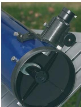
▲ L'obstruction centrale causée par le miroir secondaire dégrade la résolution de l'image.
