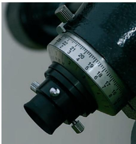
▲ *Améliorant l'orientation de l'axe polaire vers le pôle nord céleste, le viseur polaire permet une mise en station plus précise.*
