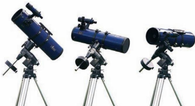
▲ Un instrument bien équilibré doit pouvoir rester dans n'importe quelle position, freins desserrés. Notez que le bas de la monture garde la mise en station.
